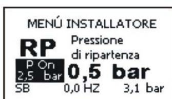
Figure 14: Configuration de la pression de redémarrage
